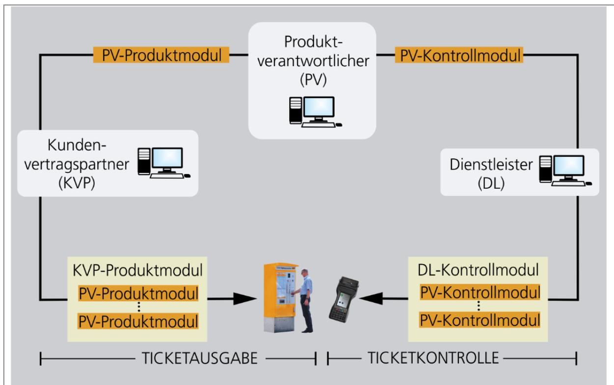
Abbildung 1: Module und Rollen des PKM-Standard (Quelle: IVI)
